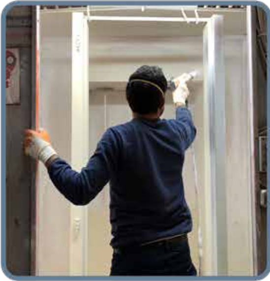
Elektrostatik Boya Uygulaması
