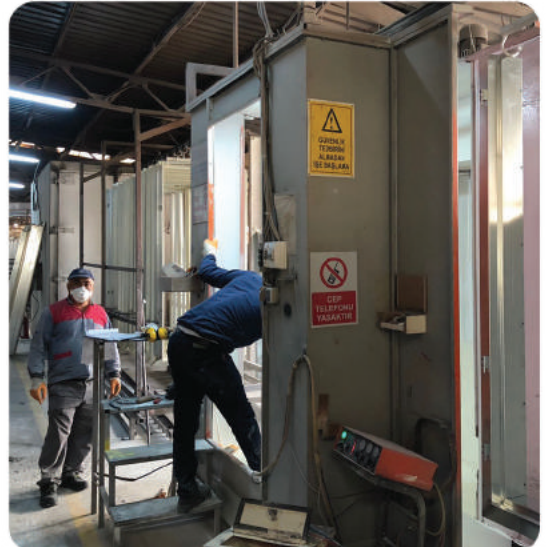
Elektrostatik toz boya ünitesi
